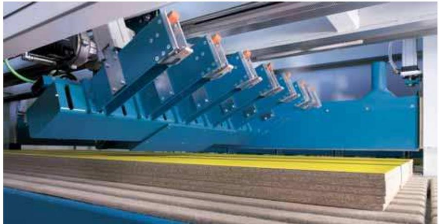
**SQUADRO TRASVERSALE IN LINEA.** Grazie al "CSFL Concept" (Cross Square Fence in Line) il pacco sezionato longitudinalmente viene avviato direttamente ai tagli trasversali senza ulteriori movimenti laterali, a vantaggio di una maggiore velocità del ciclo di sezionatura.
