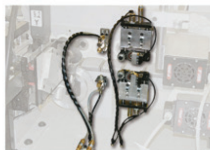
Frézovacia jednotka na olepovanie dielcov hliníkovou fóliou.
